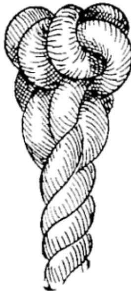
FIG. 116.—Wall knot (tucked).
